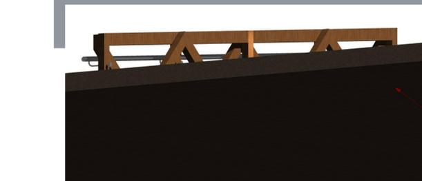
Corrimão 2 alturas em inóx, fixado por parafuso com transpasse do pilar em madeira e acabamento tipo botão chato
