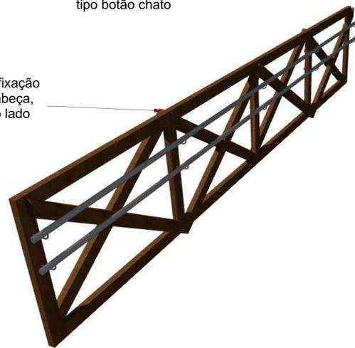
Estrutura em madeira com fixação com prego chato ou sem cabeça, com detalhe de fechamento lado interno
