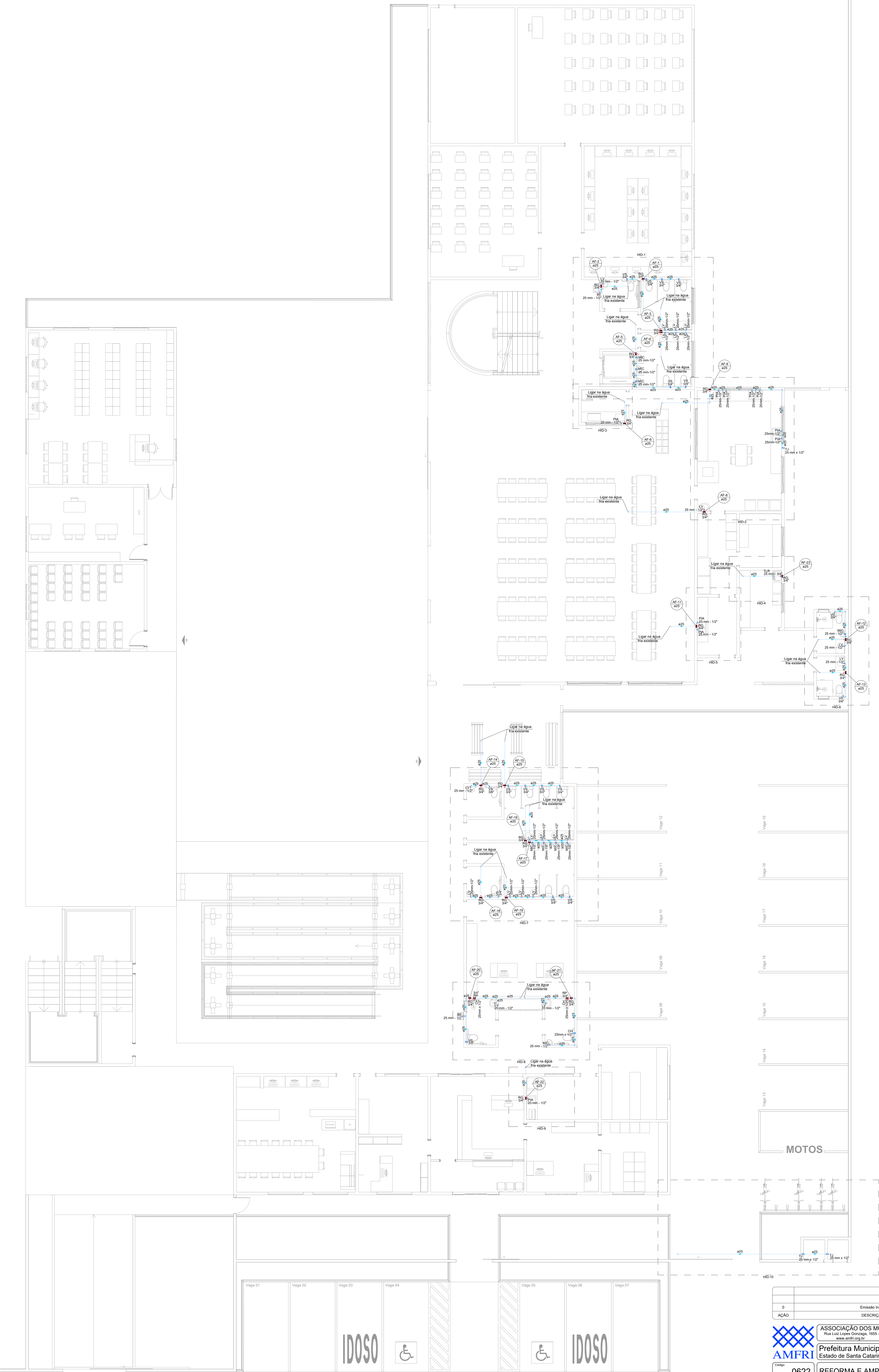
Planta Baixa Pavimento Térreo Distribuição de Água fria
