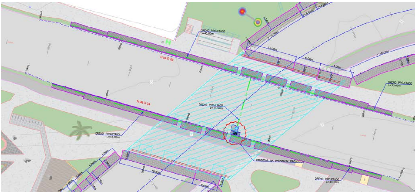
Figura 53 Dreno de PEAD do muro de concreto armado
