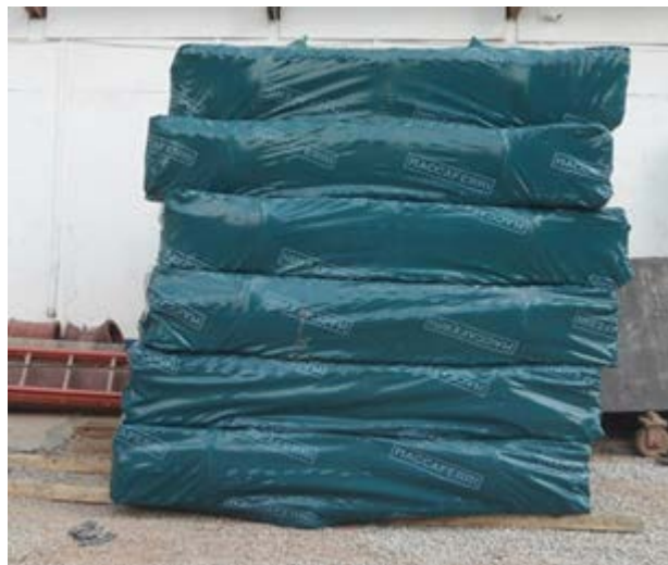
Figura 47 Elementos Solo Reforçado Verde agrupado em fardos.
