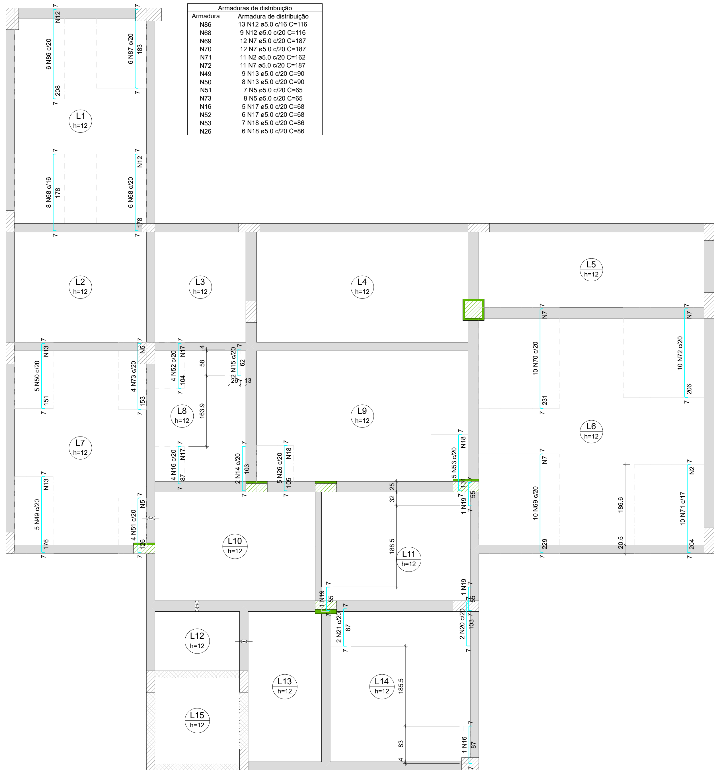
Armação negativa das lajes do pavimento Térreo (Eixo Y)
