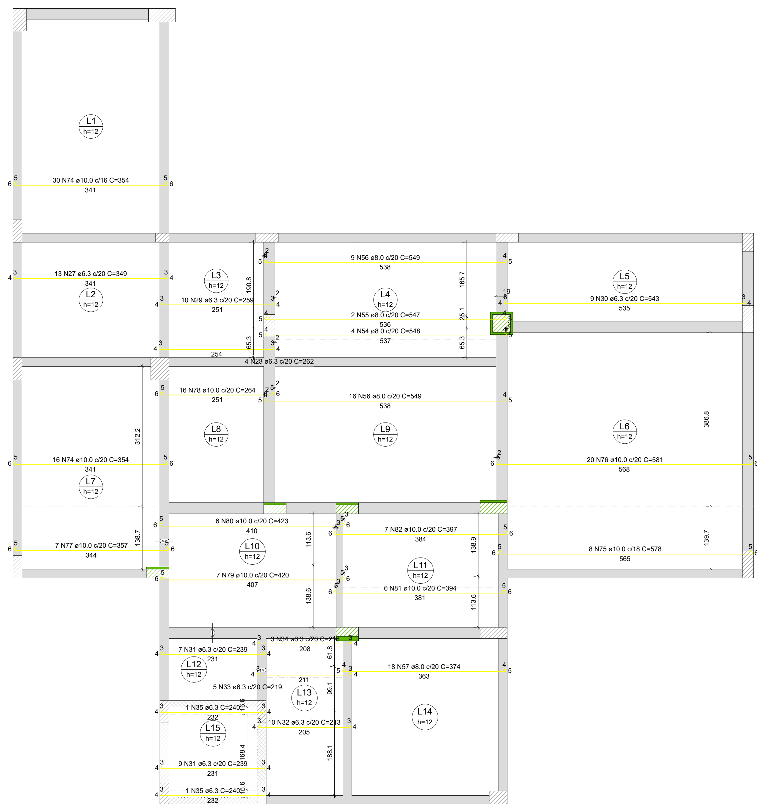
Armação positiva das lajes do pavimento Térreo (Eixo X)
