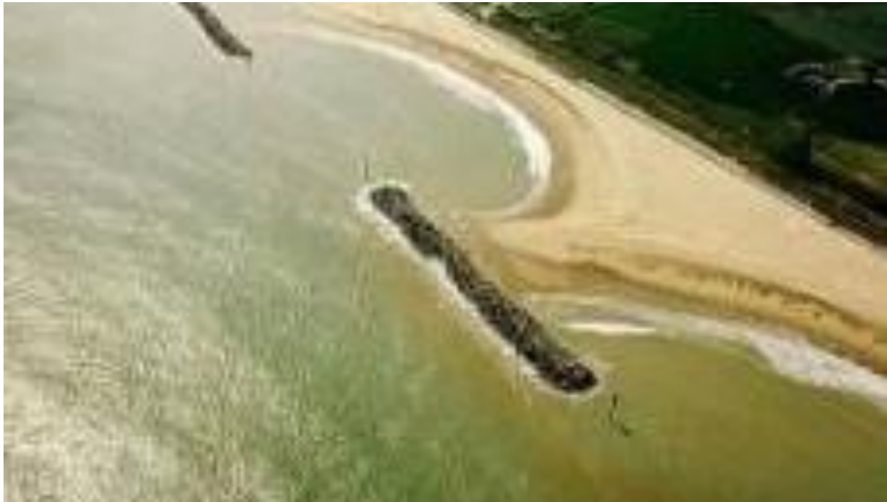
Enrocamentos paralelos produzem uma zona de sombra de ondas, onde o transporte costeiro é reduzido.
