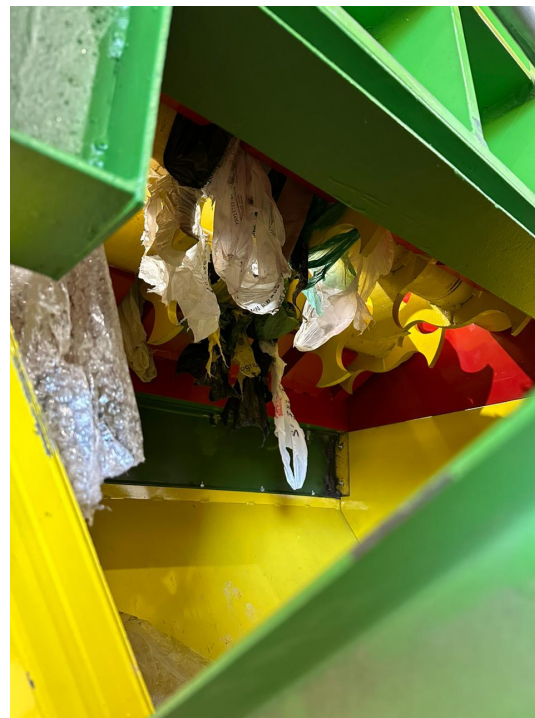
Figura 03: Detalhamento do abridor automático de sacos.
