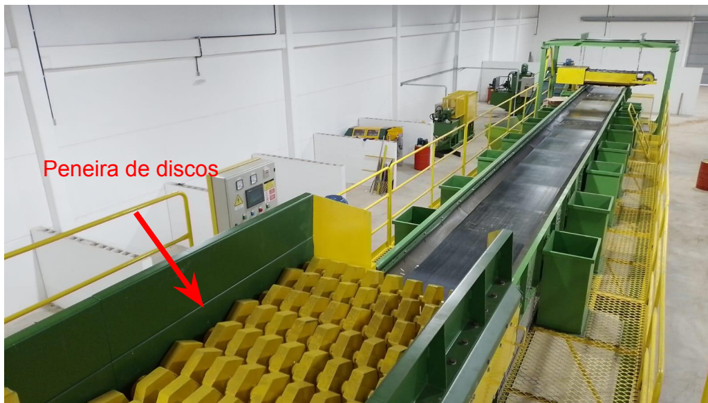
Figura 04: Segunda etapa do processo. Peneira de discos para remoção principalmente de vidros.
