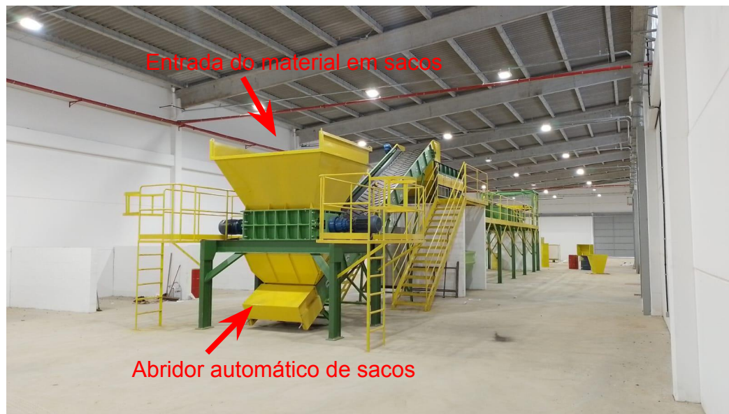
Figura 02: Vista da primeira etapa do processo. Recebimento de resíduos na linha de triagem.
